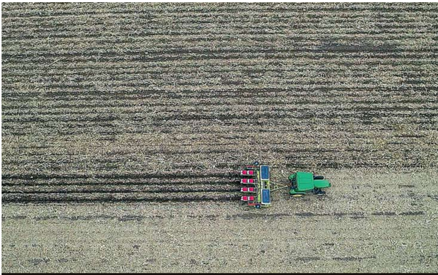
Специальный посевной комплекс для no-till-технологии разрезает землю и укладывает семена в получившиеся тонкие бороздки
