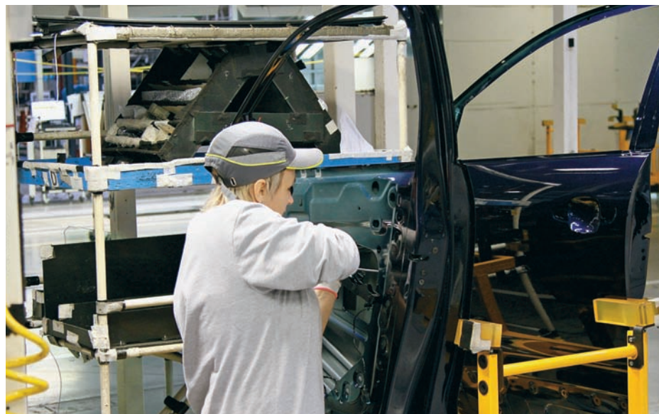
Поступивший на завод кузов сначала лишается дверей, потом их подсобирают отдельно и возвращают обратно
