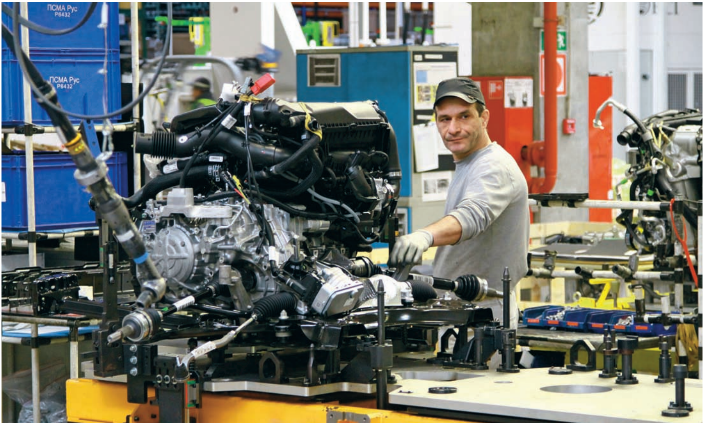
В Калуге новую модель собирают из 1700 деталей, в этом процессе задействованы 78 постов основной сборки и дополнительные 20 постов под сборки нужных компонентов
