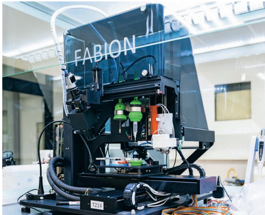
На первом в мире биопринтере Fabion был напечатан и успешно имплантирован первый в мире конструкт щитовидной железы мыши
