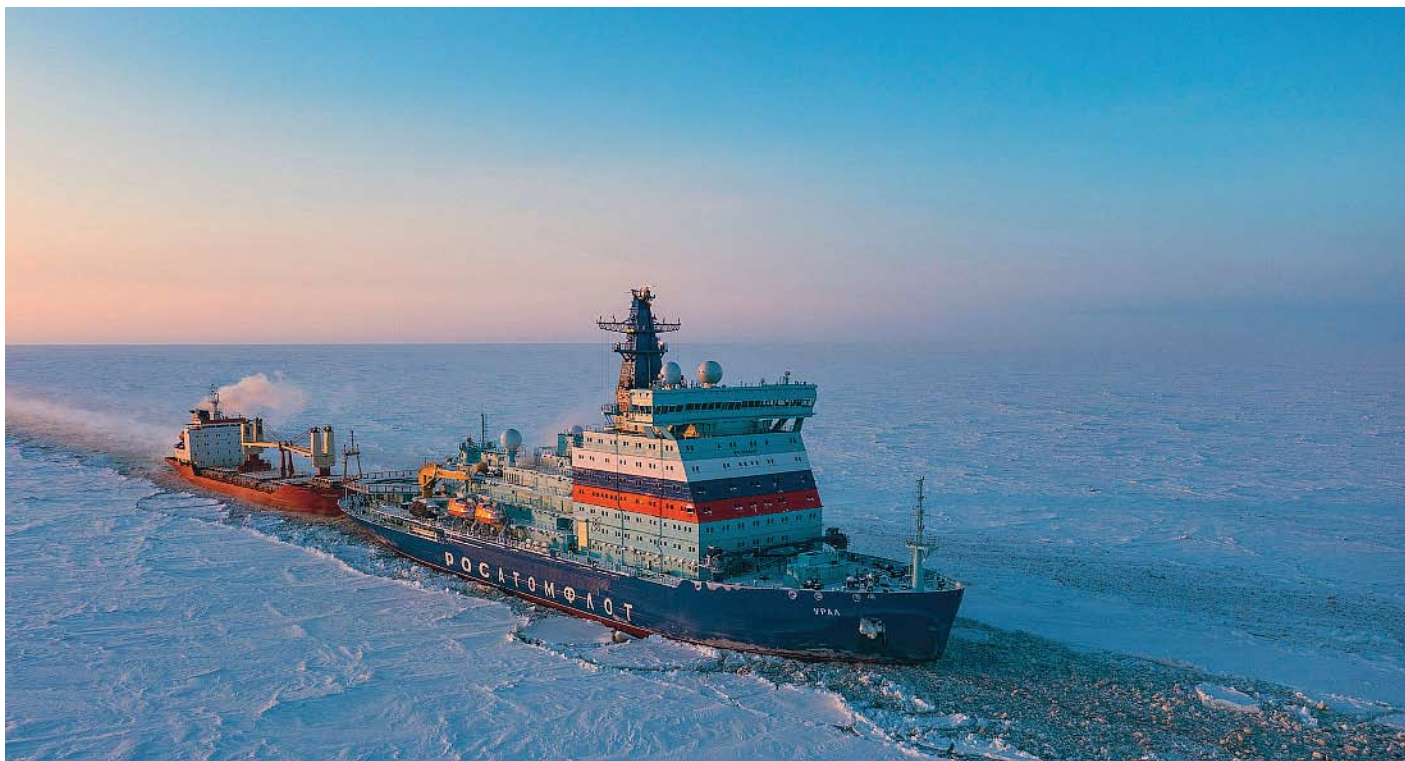
Атомный ледокол «Урал» проекта 22220 за работой. Буксировка во льдах требует синхронной работы команд обоих судов
