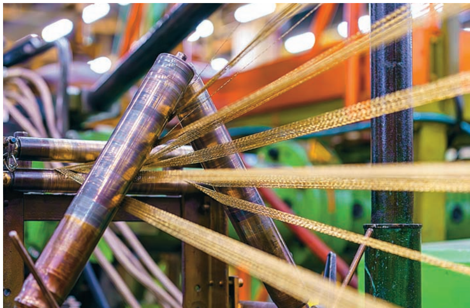
Ikon Tyres планирует развивать собственные технологии как в области подготовки резиновых смесей, так и в выпуске ключевых элементов конструкции шин, таких как каркас (на фото)
