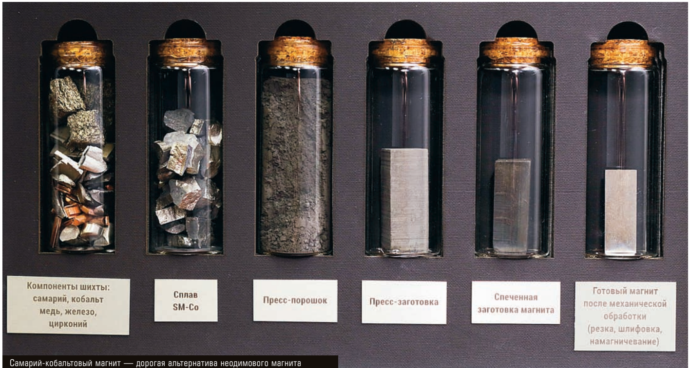
Самарий-кобальтовый магнит — дорогая альтернатива неодимового магнита
