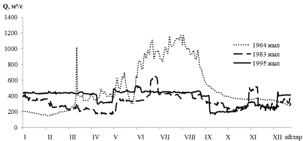
**1-сурет – Іле өзені – СЭС-тен 37 км төмен (Қапшағай шатқалы) гидрологиялық бекеті бойынша сипатты жылдарға түрғызылған су өтімдерінің гидрографтары**
