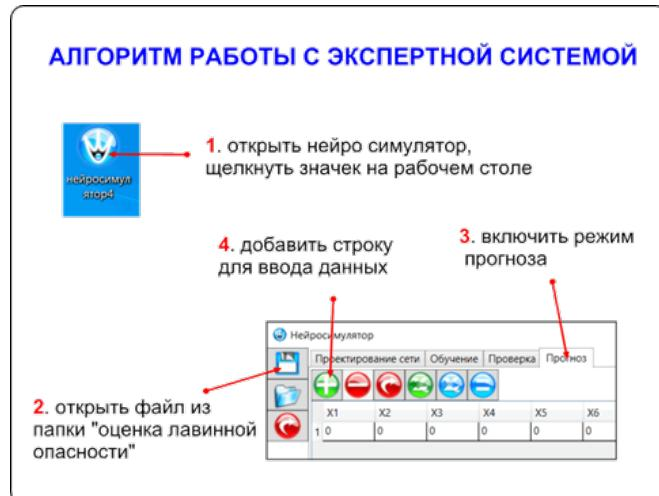
**Рисунок 3 – Алгоритм работы с автоматизированной экспертной системой, основанной на нейросимуляторе Ясницкого и Черепанова**
