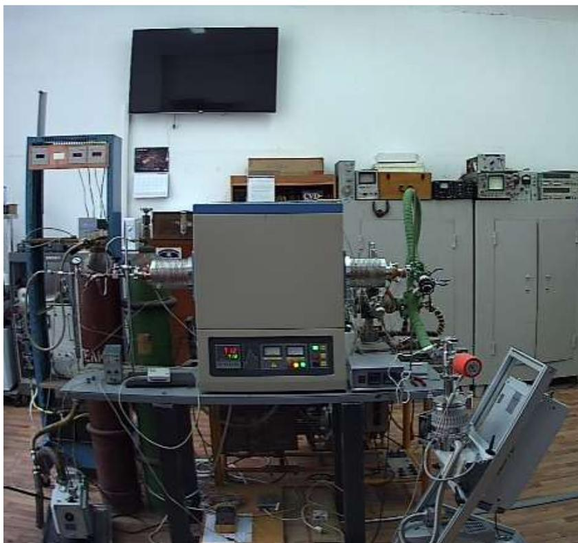
**3-сурет** – Қоррозияға қарсы қондырғының сыртқы түрі
