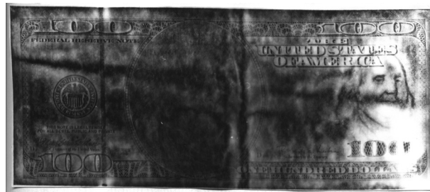
Рисунок 11 – Общий вид купюры достоинством 100 долларов США 1996 года, выполненный в поле токов высокой частоты
