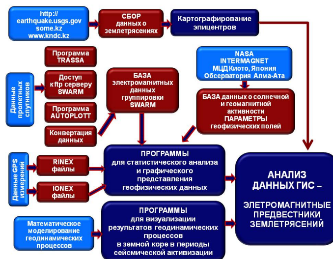
Рисунок 1 – Структура формирования информационных слоев ГИС для сбора, хранения и обработки наземных и спутниковых геофизических данных в периоды активизации сейсмических явлений на Северном Тянь-Шане
