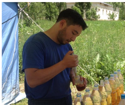
Рисунок 1 – Соосаждение изотопов урана на гидроксиде железа (III) в полевых условиях
