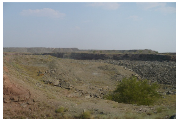
Рисунок 2 – Провалы над шахтными пустотами (близ пос.Рудник. Жезказганское рудное поле)
