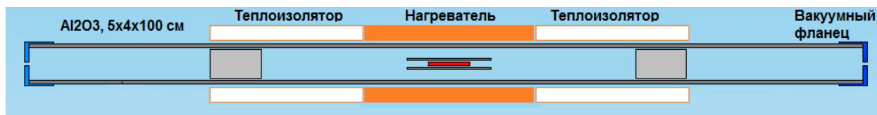
Рисунок 3 – Схема расположения элементов рабочей камеры установки CorrSiC’a
