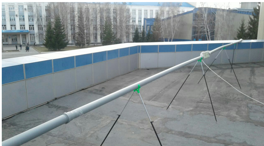
Рисунок 2 – Антенна для регистрации метеоров ЦАИ СКГУ
