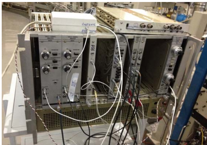
Рисунок 1 – Крейт для детектирования с использованием \Delta E -E методики
