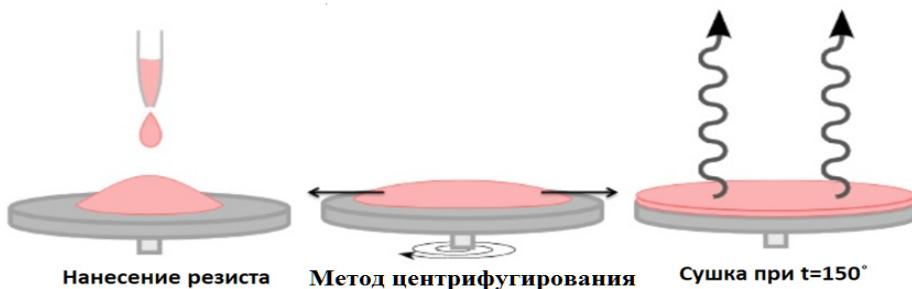
Рисунок 2 – Технология нанесения резиста на кремниевую подложку
