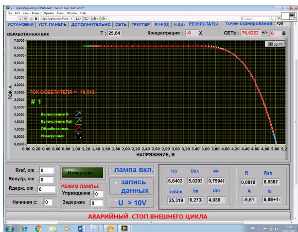
**Рисунок 5** – Скриншот измерения вольтамперных характеристик для опытного образца комбинированного преобразователя солнечной энергии с пиковой электрической мощностью 25 Вт и тепловой мощностью 80 Вт,  $T_{\text{вых}} = T_{\text{вых}} = 43^\circ\text{C}$ , 27-04-2016 13:20
