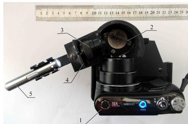
1 – цифровой фотоаппарат; 2 – дифракционная решетка; 3 – объектив; 4 – оптическая щель; 5 – освещитель.
