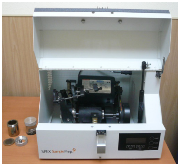
Рисунок 1 – Высокоэнергетическая шаровая мельница SPEX SamplePre 8000M
