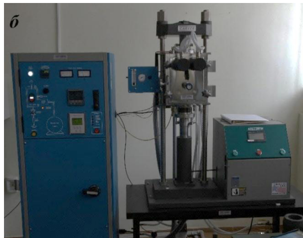
Рисунок 3 – Схематическое изображение системы горячего прессования (а) и установка горячего прессования (б)
