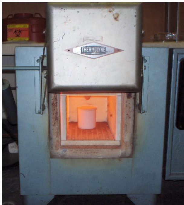
Рисунок 2 – Печь для кальцинирования порошка
