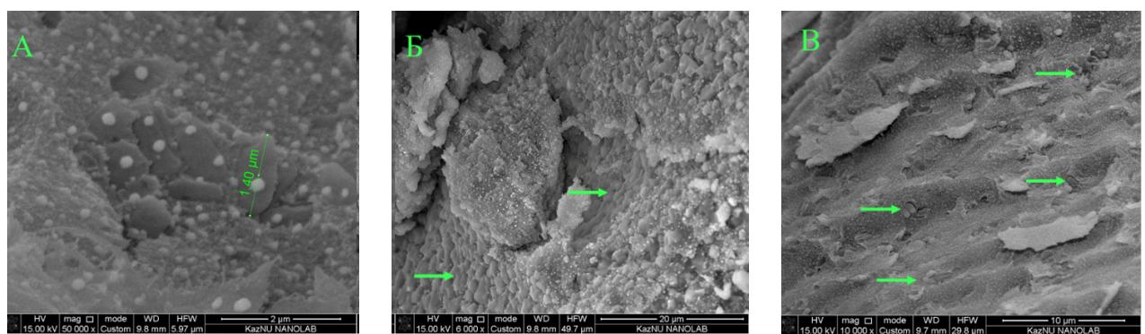
Рисунок 3 – Включение бактерий (обозначено стрелками) в микрокапсулы альгината (А),
