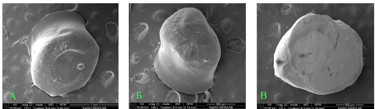
Рисунок 2 – СЭМ-изображение внешнего вида микрокапсул на основе альгината (А),
